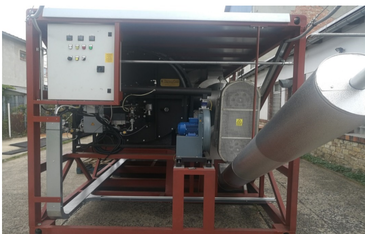
Obr. 12. Pohled na dospalovací pec v pozadí, před ní elektronika s ovládáním pece. Vpravo modré dmychadlo pro vhánění vzduchu do dospalovací pece a chlazený dopravník biocharu z retorty do připraveného sudu.
