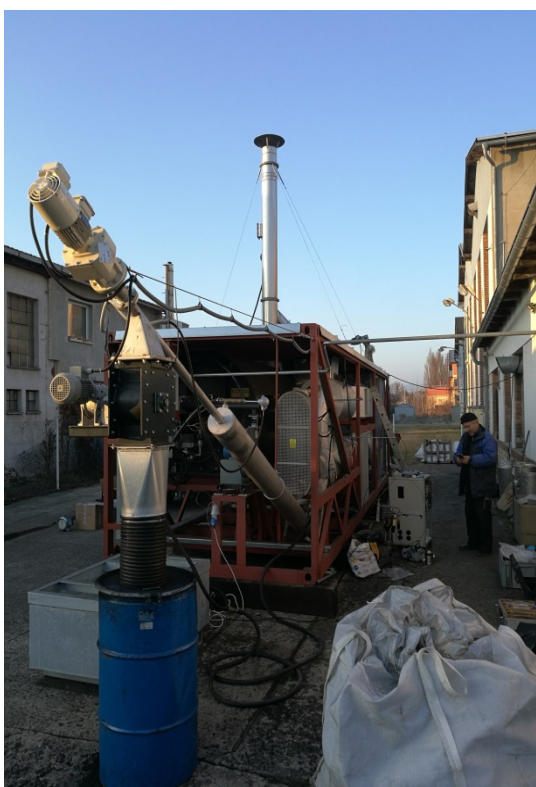
Obr. 18 a 19 instalované zařízení na chemickou analýzu vzniklého plynu vlevo, vpravo potom jímání biocharu do sudu ze kterého byly odebrány pravidelně vzorky pro chemickou analýzu.
