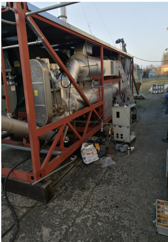
Obr. 18 a 19 instalované zařízení na chemickou analýzu vzniklého plynu vlevo, vpravo potom jímání biocharu do sudu ze kterého byly odebrány pravidelně vzorky pro chemickou analýzu.
