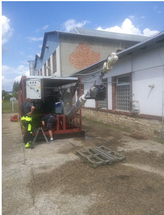
Obr. 16 a 17 pohled na celou jednotku především vstupní a výstupní část ve vyhrazených prostorách firmy Revok, kde se odehrávají i experimenty pro ověření činnosti celého zařízení a pro získávání biocharu pro další chemické analýzy.
